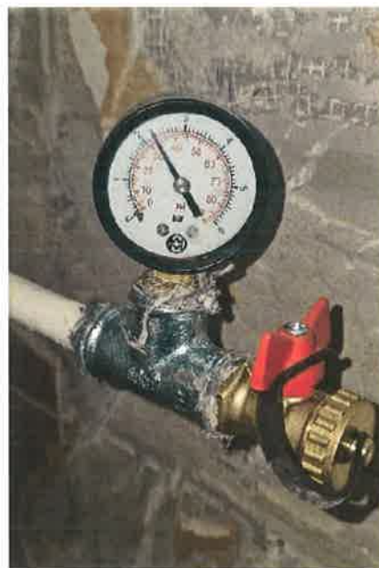
Obrázok 9 – tlaková skúška jestvujúceho potrubia
