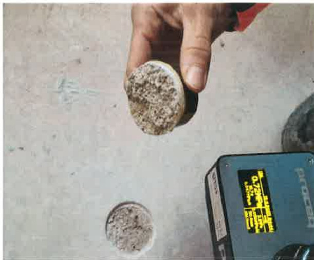
Obrázok 17 - jestuvúci poter – odtrh č.3
