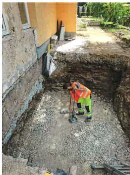
Obrázok 3 – Realizácia dynamickej zaťažovacej skúšky
