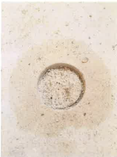
Obrázok 16 - jestuvúci poter – odtrh č.3
