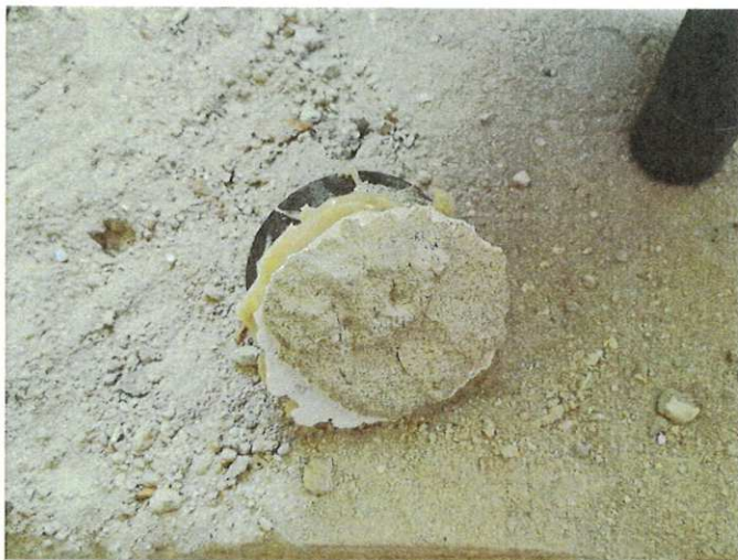
Obrázok 13 – Jestvujúci strop – odtrhová skúška č.4
